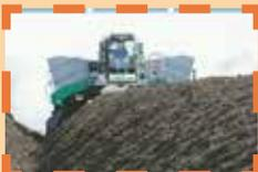
Der „Große Maulwurf Gregor“ ist eine Umsetzmaschine, die Luft und Wasser in den Kompost bringt, damit Bakterien und Mikroorganismen gut arbeiten können.
