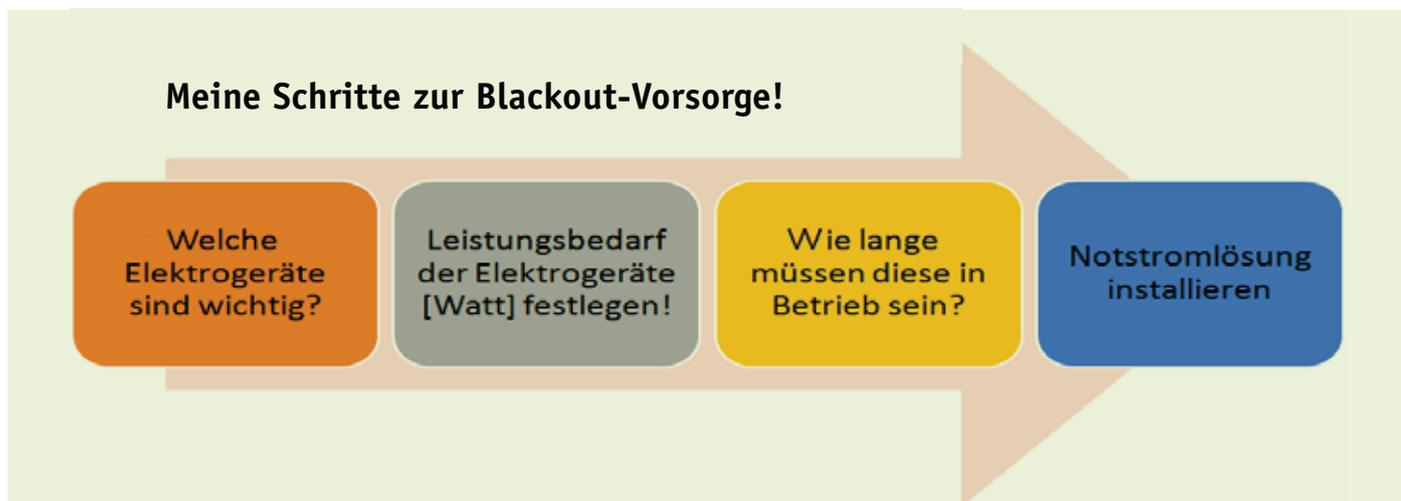
▶▶▶ 3) Nach Ermittlung der erforderlichen Leistung bestimmt die Betriebsdauer der Elektrogeräte die Größe des erforderlichen Energiespeichers (Batteriegröße, Menge an Benzin/Diesel).
